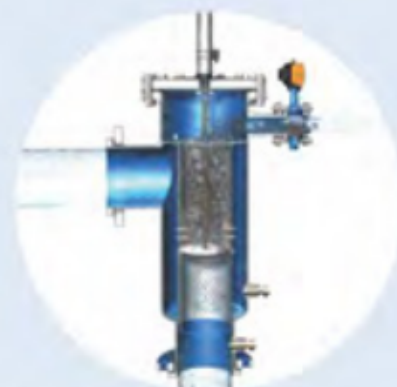
Фильтрация. 2-я стадия очистки. Очищающий фильтр опускается внутрь сетки дважды, создавая эффект Бернулли, тем самым отрывая от сетки остатки загрязнений.
