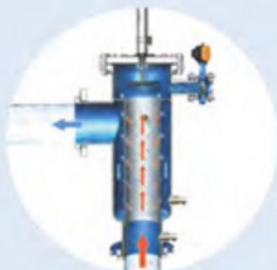
Работа в режиме фильтрации. Диск находится вне корзины фильтра.
