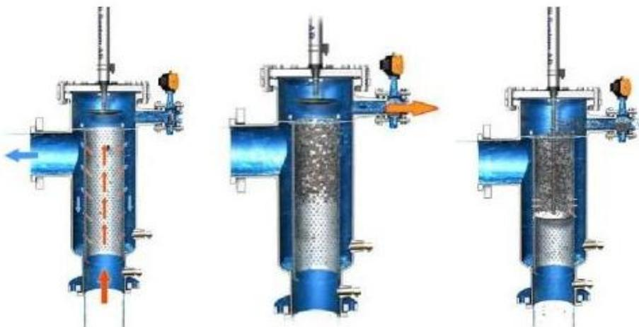
воды, которая проходит через зазор между диском и корзиной. Снижение давления, возникающее из-за увеличения скорости потока между сеткой с загрязнениями и кромкой диска, приводит к перепадам давления в фильтре, исходя из принципа Бернулли, эта сила позволяет отрывать частички загрязнений с внутренней поверхности фильтра.
